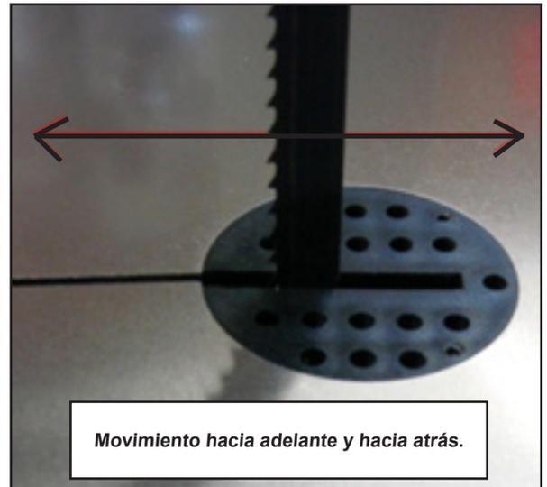
**NOTA:** Las hojas de 1/8" (3,18mm) deben tener un calibre de 0,018" a 0,020" para reducir los inconvenientes de alineación frecuentes con este ancho.
